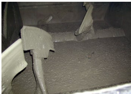
После добавления суперпластификатора и 3 минут перемешивания
